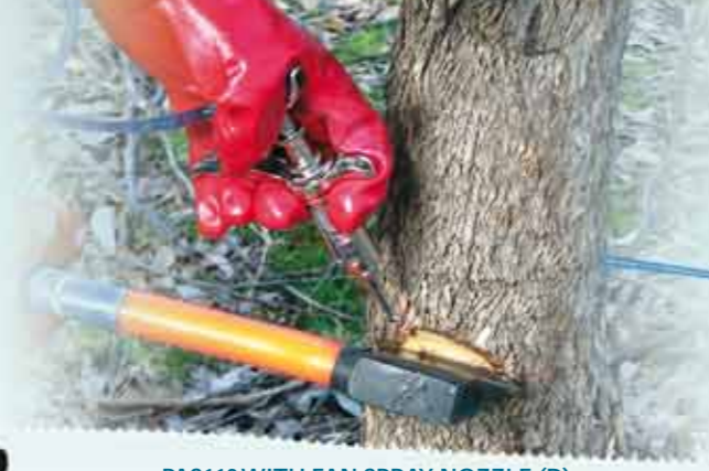
PAS118 WITH FAN SPRAY NOZZLE (D) SHOWING CUT STUMP INJECTION.
